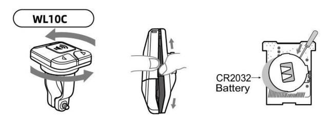
Поверните пульт по часовой стрелке/против часовой стрелки и выньте его из крепления.
