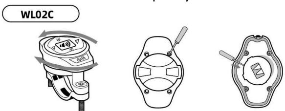
Поверните пульт по часовой стрелке/против часовой стрелки и выньте его из крепления.
